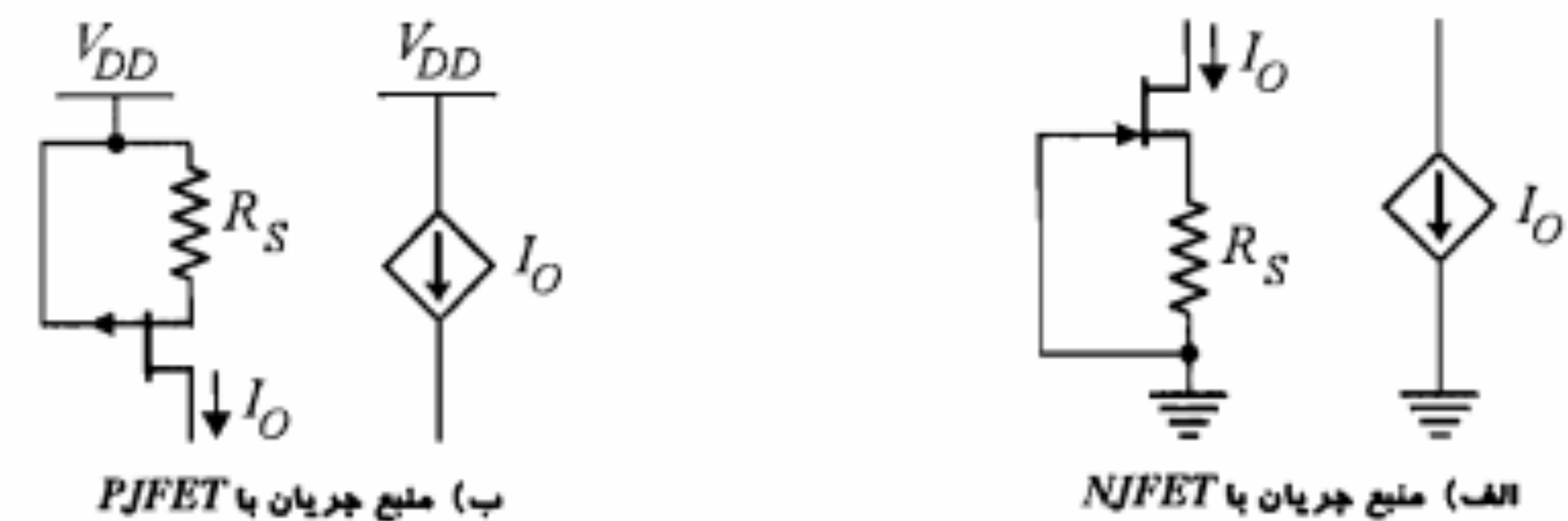
شکل ۷-۱۸: مدارهای منبع جریان با JFET
